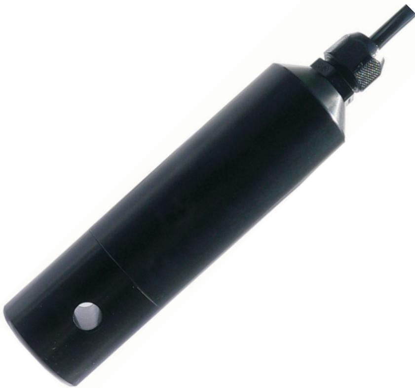
A sonda de salinidade OxyGuard foi especialmente projetada para uso em aquicultura. A calibração de fábrica e a compensação automática de temperatura tornam seu uso muito fácil. Ela está disponível em duas versões. Uma é um sensor de 3 fios com corrente de saída de 4-20 mA – conecte-a a 24 VCC e a saída variará entre 4 e 20 mA de acordo com a salinidade. A outra possui conexão de barramento de dados para uso com o OxyGuard Pacific.
